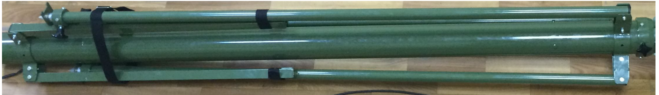
Рисунок 1.2.7.1 – Внешний вид мачты с треногой в собранном состоянии
