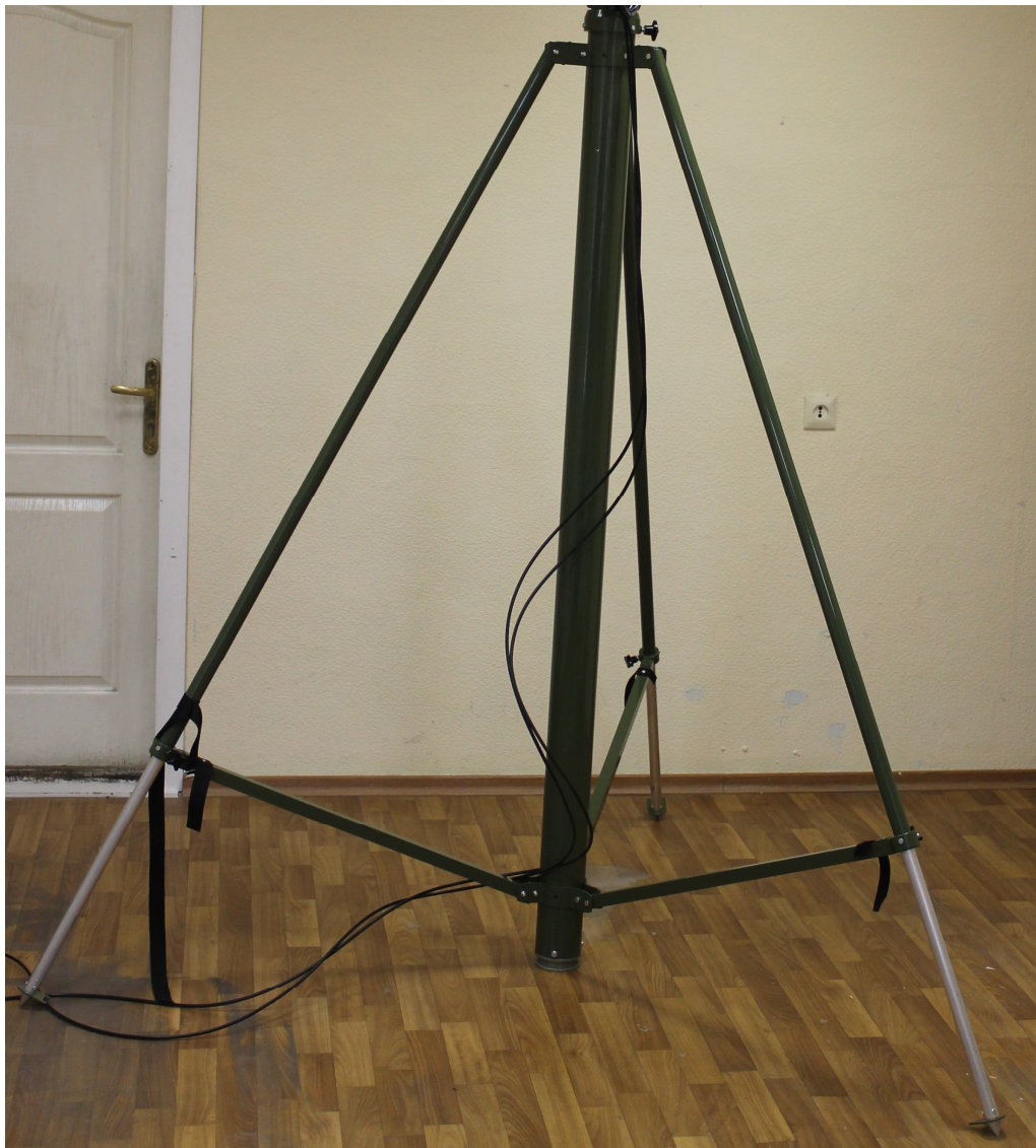
Рисунок 1.2.7.2 – Внешний вид мачты с треногой в развернутом состоянии
