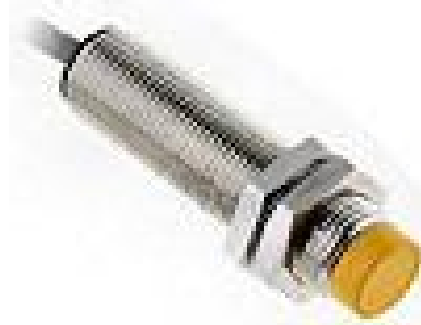
Рисунок 1.2.6 – Внешний вид индуктивных датчиков типа LM12-3004PC
